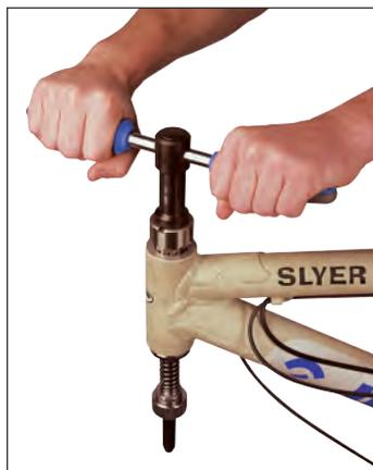
El giro sin defectos de la rueda delantera y una tracción confiable dependen del rulemán de empuje, que une la horquilla con el cuadro de la bicicleta. Cuando los rulemanes comienzan a trabarse por el desgaste, corregimos el paralelismo de la superficie del tubo de empuje mediante la herramienta adecuada. Con en barrenado del tubo de empuje logramos que éste se adapte óptimamente a la taza del rulemán de empuje.
