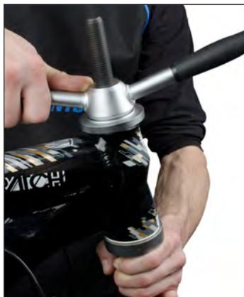
Esta herramienta se utiliza para el posicionamiento alienado de la taza inferior y superior del cuadro de la bicicleta. La herramienta sirve para todos los tipos de tazas desde 1", 1 1/8", 1 1/4" y 1 1/2"; el eje es más largo con el fin de poder posicionar las tazas de bicicletas BMX con un cuadro más grande. La herramienta está fabricada en forma muy precisa de tal forma que en el posicionamiento de las tazas no se producen daños.
