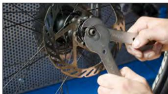
La llave doble para conos está diseñada a los aficionados de la reparación, así como a los talleres de servicio profesionales. Se destaca por su delgadez, la cual permite el montaje o desmontaje del cubo y otras tuercas estrechas. La ventaja de esta llave es de la de asociar cuatro dimensiones, lo cual lo hace muy versátil en el uso de reparaciones diarias en el mantenimiento de la bicicleta.
