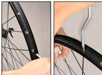
Una herramienta fundamental para el armado de ruedas. Mango giratorio y la forma de guía permite atornillar la boquilla al radio rápidamente. Admite boquillas con forma estándar.
