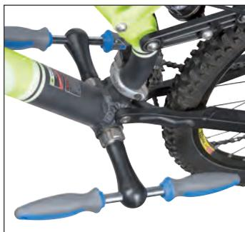
Para la rectificación o corte de roscas en el marco del rodamiento motor, se utiliza la cuchilla especial de roscas. Principalmente para ruedas de producción italiana, que tienen a ambos lados del rodamiento motor rosca derecha (36 mm x 24 tpi), lo que significa que a ambos lados está previsto el destornillado en el sentido opuesto a las agujas del reloj. Con la cuchilla de roscas se puede rectificar la rosca.
