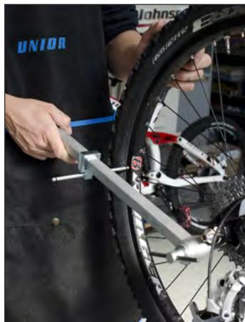
El soporte de caja de cambios y el último elemento que está fijado en este soporte debe estar paralelo al último engranaje, para asegurar la marcha tranquila de la cadena y un cambio de velocidades rápido y eficaz.
