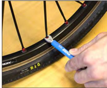
Para el centrado de niples de rayos de 5 y 5,5 mm. El cuerpo plastificado permite un cómodo trabajo. La longitud de la llave es de 100 mm.
