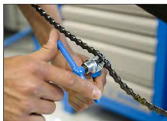
La herramienta para el montaje y desmontaje de la cadena es idónea para los usuarios profesionales y para quienes gustan hacer sus propias reparaciones. Con el simple ajuste del eje, el punzón se acomoda exactamente sobre el remache de la cadena y permite un uso rápido, exacto y eficaz de la herramienta. La forma ergonómica de este, le concede al usuario una ventaja adicional antes de resto de las herramientas similares.
