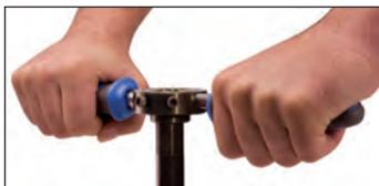
Esta herramienta está diseñada para roscar, así como para reparación de roscas en la parte no cromada del tubo de la horquilla. La hoja de corte está fabricada de acero de alta calidad, lo que brinda una vida útil muy larga. Se posiciona la herramienta sobre el tubo de la horquilla bajo el ángulo de 90°. Durante el trabajo se utiliza el aceite para tal fin. El mango eronómico permite la transferencia máxima de la fuerza y una alta eficiencia.
