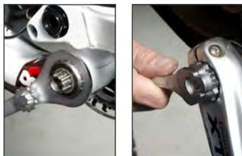
del eje, sin deslices y danos sobre el eje o sobre la llave. La llave tiene un accesorio especial para desatornillar el tapón plástico sobre el eje de tracción.
