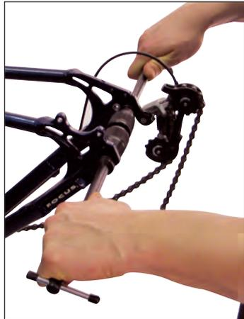
Primero retire la rueda y luego inserte la herramienta al cuadro de la bicicleta. Esta herramienta se utiliza para el control y alineación de la horquilla trasera con el fin de lograr que sea paralela.
