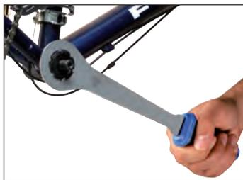
La llave se ajusta exactamente al eje de centro de XTR® (M950) y Dura Ace, lo cual permite un fácil ajuste y desajuste del eje, sin deslices y danos sobre el eje o sobre la llave.
