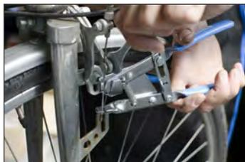
La función básica de estas pinzas el estiramiento, el tensar los cables trenzados metálicos de los frenos y de los cambios. Agarramos el cable interior y lo extraemos; presionamos hacia arriba la manivela de freno hasta que salta; soltamos las pinzas y fijamos el cable. Finalmente, sólo apretamos las manivelas y el mecanismo de cierre se libera automáticamente. El mecanismo de cierre adicional permite un trabajo más fácil y más rápido sin esfuerzos notables.
