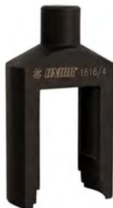
Este accesorio se utiliza para el desmontaje del cono del manillar de diferentes dimensiones y con la ayuda de un martillo permite un desmontaje sencillo del cono del manillar. Con un solo golpe firme sobre la barra se desmonta el cono del manillar.
