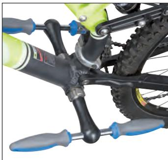
Esta herramienta de precisión se utiliza para roscar las partes izquierda y derecha del centro del cuadro. Inserte el taladro a través del alojamiento del eje del pedalier en el cuadro.
