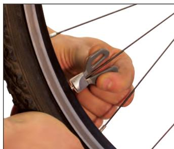
La llave para nipples de rayos se utiliza para el centrado de los rayos de dimensión 3.3 mm y 3.45 mm.
