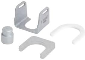
El juego de herramientas 1626.1A es usado junto al juego de herramientas 1626/2 para la extracción e instalación de la totalidad de los rodamientos Campagnolo Ultra Torque. Se utiliza para extraer los cigüeñales Power Torque standard y extraer los rodamientos de este cigüeñal.
