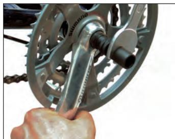
Esta llave se utiliza para el desmontaje del eje de tracción y para el desatornillado de los pernos con rosca de tuerca de 14 mm. El acero de alta calidad y la pequeña dimensión de la herramienta permite realizar el trabajo en sitios de difícil acceso. El diseño de la herramienta permite una utilización óptima y es conveniente tanto para usuarios profesionales como para los aficionados de las reparaciones domésticas.
