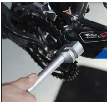
Sirve para la reparación de pequeñas fallas en la corona. La ranura más estrecha está destinada al enderezamiento del engranaje de la corona, y la más ancha al del soporte del engranaje.
