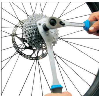
Las uniones son aplicables: para el agarre de rueda libre de 11 y 12 dientes. Con la llave, que colocamos en el engraje (11 o 12 dientes) de la caja dentada, fijamos la caja y, al mismo tiempo, a través de la abertura central de la llave, con la llave para el engranaje trasero llegamos hasta la tuerca de seguridad de los engranajes.
