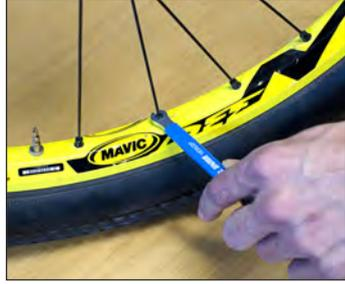
Para el centrado de niples sistema Mavic. El cuerpo plastificado permite un cómodo trabajo. La longitud de la llave es de 100 mm.
