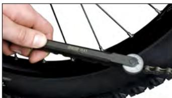
eslabones; repetimos la operación en distintos fragmentos de la cadena. Los fabricantes recomiendan el cambio de la cadena cuando el estiramiento, o bien el desgaste, superan los 0,5 o 0,6 mm en un fragmento de 10 eslabones a lo largo.
