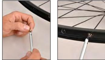
La herramienta Unior para armado de boquillas es su mejor amigo a la hora de armar ruedas. Su resorte firme le permite simplemente colocar la boquilla y atornillarla a través de una llanta de pared doble en el radio. De esta forma, evita perder boquillas entre las paredes de las llantas.
