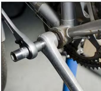
El ratchet reversible puede ser utilizado para apretar o aflojar tuercas de dimensión 14 mm y 15 mm es especialmente recomendable para el montaje o desmontaje del eje de centro.
