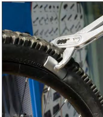
La pinza para acomodar la llanta al rin sirve para un rápido y simple desarme de los neumáticos, especialmente de aquellos que han quedado fuertemente adheridos a la llanta. La forma de las pinzas separadoras, inteligentemente diseñada, impide que durante el proceso pueda producirse daño a la llanta. La pinzas es cromada; los mangos, para un mejor agarre, revestidas en plástico.
