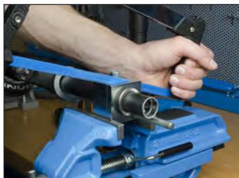
El medidor 1604.1/2PLUS encaja en la guía de corte 1604/2PLUS y permite una rápida y precisa determinación del largo deseado del tubo de horquilla luego del corte.
