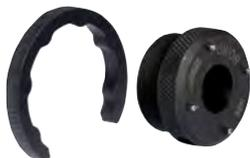
El extractor se utiliza para desmontar las nuevas coronas XTR. Con ayuda de cuatro tapones en el lado izquierdo del liberador, destornillar el anillo de plástico de la parte exterior de la corona; después desenroscar la tuerca con la agarradera de plástico, hasta que se separa de la corona. El producto permite una óptima utilidad tanto para uso profesional como de aficionados.
