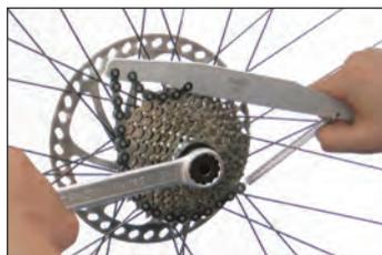
La llave está diseñada para el desmontaje de todo tipo de coronas, inclusive de tipo cassette. Permite un trabajo eficaz y de precisión sin resbalones o daños, ya que la cadena se adapta perfectamente a los dientes de la rueda libre. El resorte adicionalmente aumenta la funcionalidad de la herramienta, lo que añade a esta llave una ventaja adicional.
