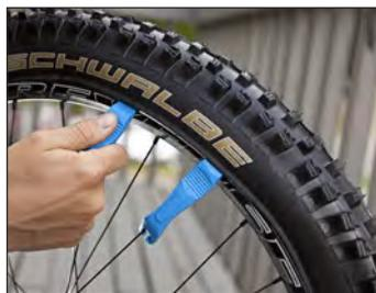
el juego de dos palancas le permite quitar fácilmente los neumáticos. Están hechos de plástico duro y permite trabajar sin hacer ningún tipo de daño en la llanta. Útil para cada usuario profesional mecánico o el uso en casa.
