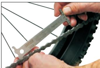
Para un control fácil del grado de desgaste de la cadena. Con los picos de medición, que colocamos entre los eslabones de la cadena, comprobamos el grado de desgaste. El chequeador está diseñado para medir 10 eslabones a lo largo; repetimos la operación en distintos fragmentos de la cadena.
