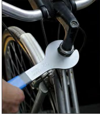
La forma especial de la llave permite el trabajo en las partes de difícil acceso. Está diseñada especialmente para el montaje y desmontaje de los manillares de las bicicletas SUN TOUR. Se puede utilizar en combinación con la llave art. 1617 (llave para conos). La forma ergonómica de la llave permite una adaptación máxima a la mano.
