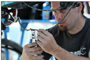
Missing Link. Luego del uso ocasional de la cadena y debido al lodo y óxido, es casi imposible remover el eslabón maestro con el sólo uso de sus manos. Con las Pinzas para Eslabón Maestro Unior 1720/2DP, la extracción del eslabón maestro es muy sencillo.
