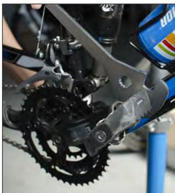
La llave profesional para pedales tiene tres aberturas de 15 mm bajo diferentes ángulos, lo cual permite un desmontaje exacto y eficaz del pedal, indistintamente de su posición. La forma y la fabricación de la llave garantiza su durabilidad, resistencia y exactitud durante el trabajo. La longitud de la llave de 350 mm facilita una fuerza suficiente para desatornillar los pedales más ajustados.
